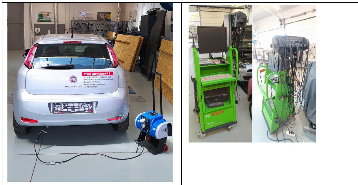
Rys. 41. Badania na hamowni podwoziowejz wykorzystaniem analizatorów FSA 740 + KTS540 oraz opracowanych systemów telemetrycznych
