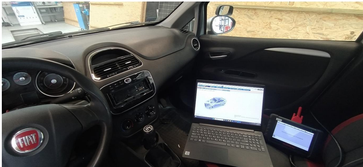
Rys. 34. Zestawiony układ monitorowania z czytnikiem OBD.
