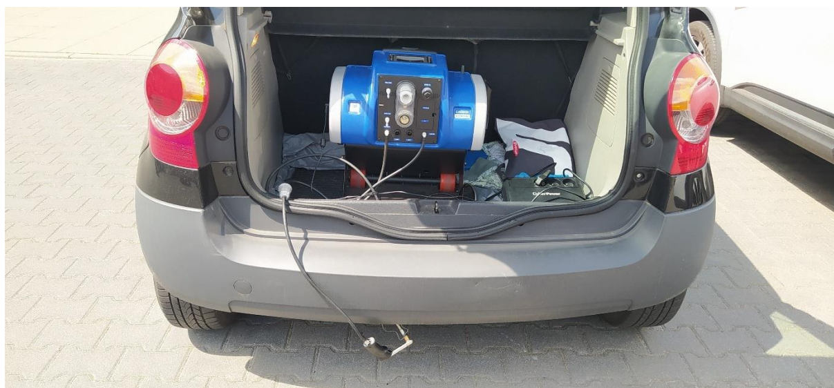
Rys. 43. Widok kompletnego układu mobilnego pomiaru toksyczności spalin zamontowanego w pojeździe
