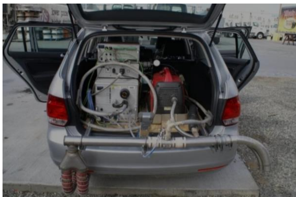
Rys. 15. Urządzenie, które umożliwiło wykrycie nieprawidłowości w pojazdach marki VW [EPA]
