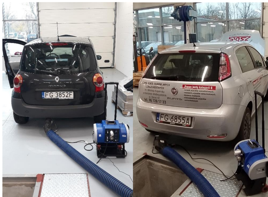
Rys. 39. Obiekty badań P1 i P2. Pomiar z wykorzystaniem analizatora Gasbox
